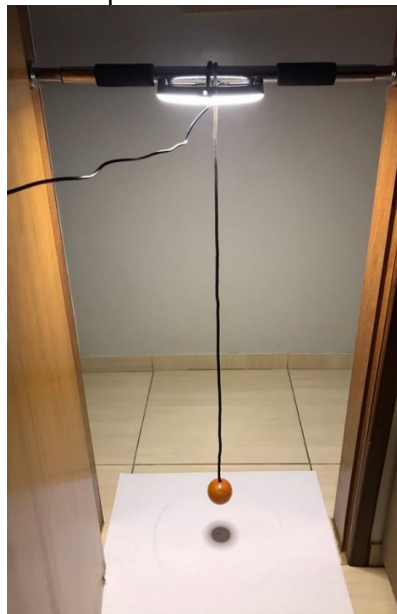
Figura 1: Pêndulo cônico constituído por um corpo preso a um ponto fixo por um fio de comprimento conhecido
